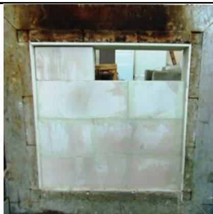
شکل ۴: اجرای بلوک‌های AAC در قاب کوره توسط شرکت سیلیس آرا
