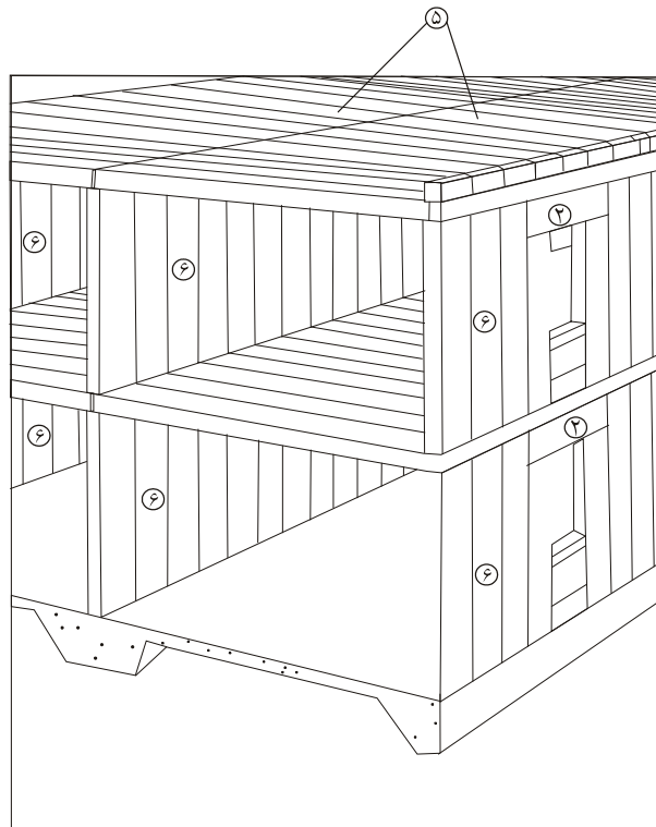
شکل ۱۶-۲ این ساختمان پنج طبقه در مکزیکوسیتی که با دیوار AAC به ضخامت ۱۲/۵ cm به عنوان دیوار باربر ساخته شده است، در برابر زلزله ۸/۱ ریشتری ۱۹ سپتامبر ۱۹۸۵ مقاوم ایستاد.
