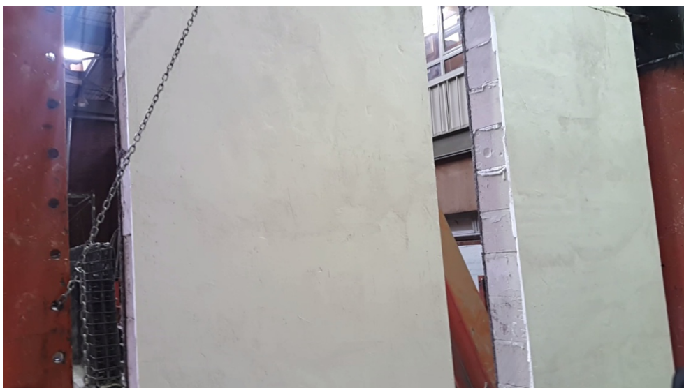
شکل (پ ۸-۲) نتیجه آزمون ضربه انجام شده بر روی دیوار AAC با یک لایه الیاف شیشه در دو طرف
