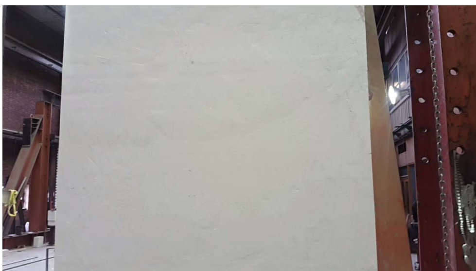
شکل (پ ۲-۱۵) نتیجه آزمون ضربه انجام شده بر روی دیوار AAC با ضخامت ۲۰ سانتی متر بدون لایه الیاف شیشه
