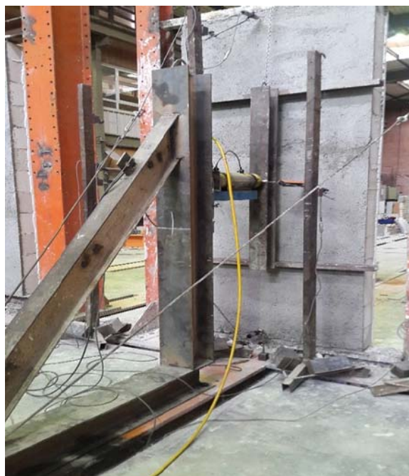
شکل (پ ۲-۱۱) بارگذاری خمشی پانل (۴ نقطه ای) بر اساس استاندارد ملی ایران
