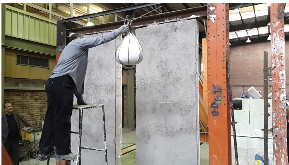
شکل (۳-۷) آزمایش ضربه جسم نرم سنگین
