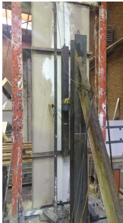
شکل (پ ۳-۲) بارگذاری خمشی پانل ( ۴ نقطه ای ) بر اساس استاندارد ملی ایران
