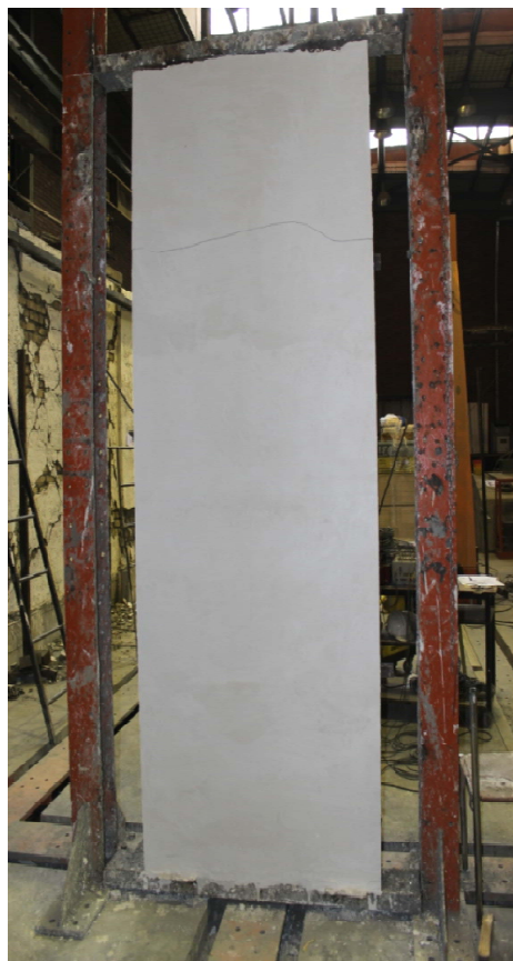
شکل (پ ۳-۲) بارگذاری خمشی پانل ( ۴ نقطه ای ) بر اساس استاندارد ملی ایران
