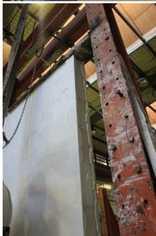
شکل (پ ۲-۱۹) نتیجه آزمون ضربه انجام شده بر روی دیوار AAC با ضخامت ۱۰ سانتی متر بدون لایه الیاف شیشه
