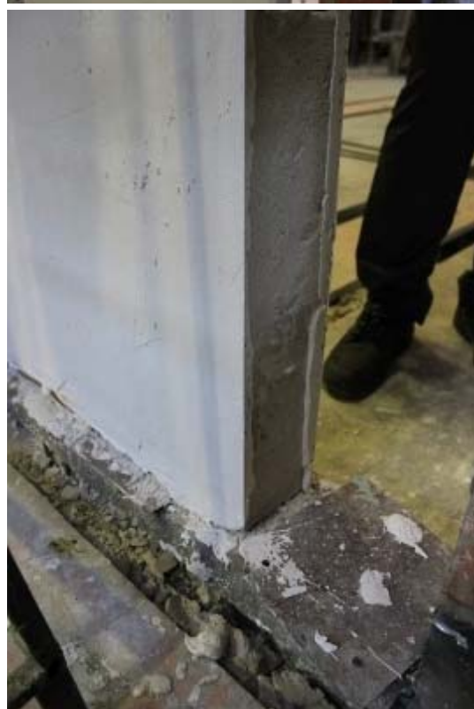
شکل (پ ۲-۱۹) نتیجه آزمون ضربه انجام شده بر روی دیوار AAC با ضخامت ۱۰ سانتی متر بدون لایه الیاف شیشه
