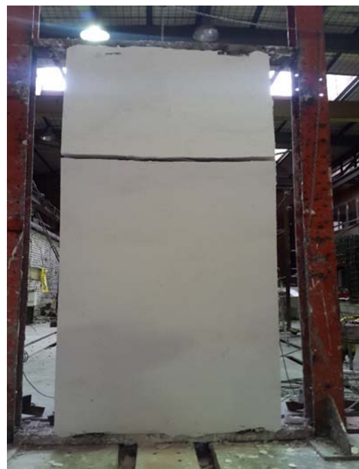
شکل (پ ۲-۱۱) بارگذاری خمشی پانل (۴ نقطه ای) بر اساس استاندارد ملی ایران
