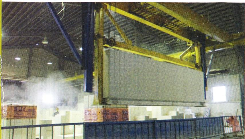
مخلوط بتن سبک با عنصر سیمان، آهک، پودر آلومینیوم، سیلیس و آب به میزان لازم در قالب‌هایی که بر روی ریل حرکت می‌کنند ریخته می‌شود (به صورت نیمه‌پر). قالب به مدت زمان مشخص در گرمخانه براثر واکنش شیمیایی گرمایشی حاصل از ترکیبات و هیدراتاسیون سیمان و همچنین واکنش با آلومینیوم، حجم مواد
